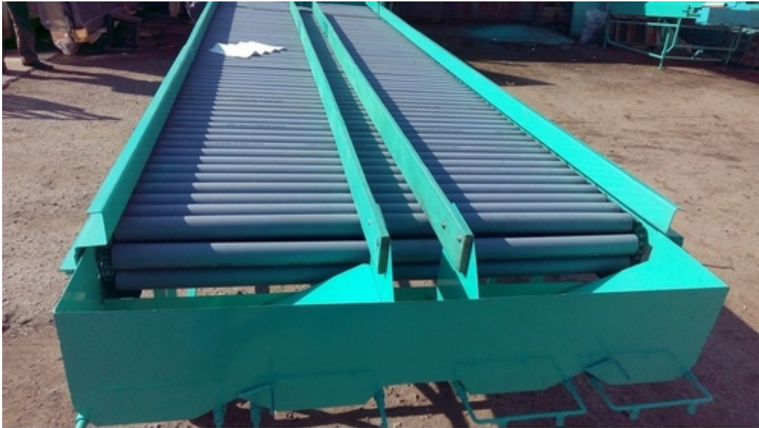
Стол инспекционный с приводом мотор-редуктором и регулировкой скорости перемещения
