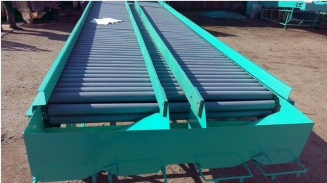
Стол инспекционный с приводом мотор-редуктором и регулировкой скорости перемещения
